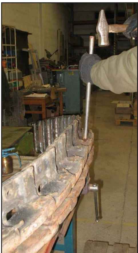
Demontering av bandbult
