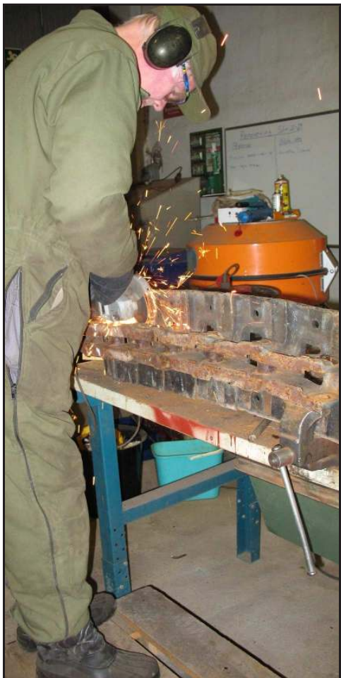
Borttagning av låspinne från bandbult
